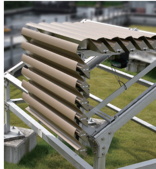
騒音試験架台に設置されたモックアップ
